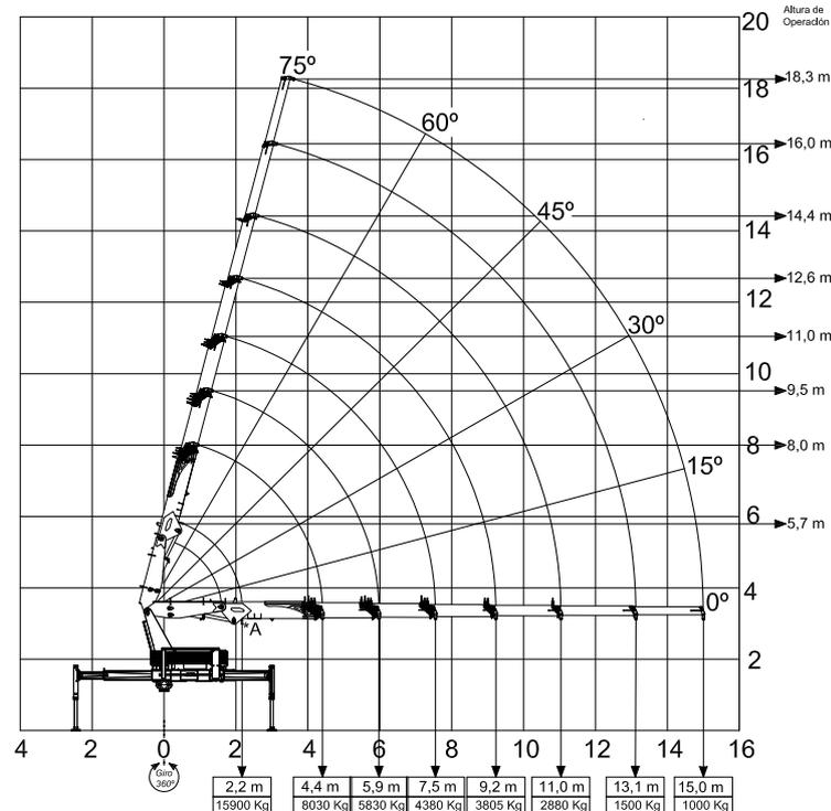
\* El punto A es para izar cargas especiales, debiendo ser utilizada un grillete de unión Ø1,3/4" grado T.
