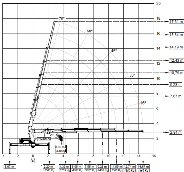
\*A El punto A es para izar cargas especiales, debiendo ser utilizada un grillete de unión Ø1" grado T.
