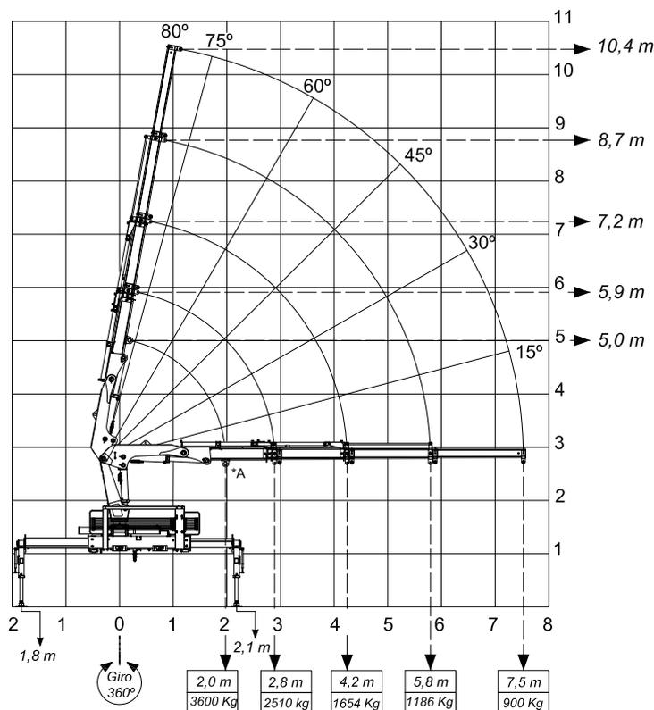
\* El punto A es para izar cargas especiales, debiendo ser utilizada un grillete de unión Ø1.3/4" grado T.
