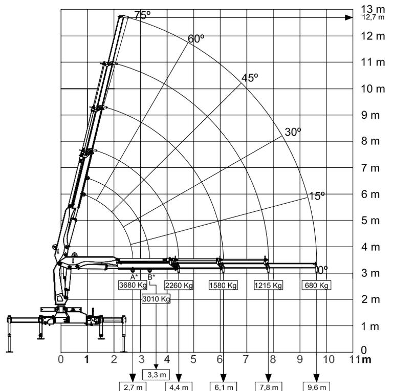
\* El punto A y B es para izar cargas especiales, debiendo ser utilizada un grillete de unión Ø3/4" grado T. Feriali S.A. se reserva el derecho de cambiar o alterar la información contenida en esta especificación técnica sin previo aviso y a criterio del fabricante.
