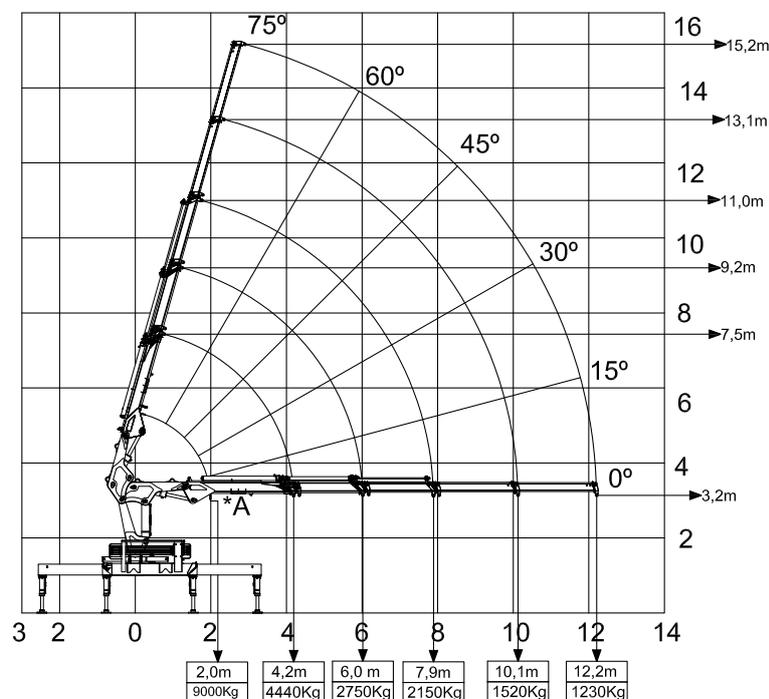
\* El punto A es para izar cargas especiales, debiendo ser utilizada un grillete de unión Ø1" grado T.
