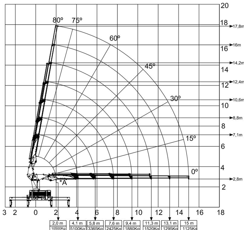
\* El punto A es para izar cargas especiales, debiendo ser utilizada un grillete de unión Ø1" grado T.
