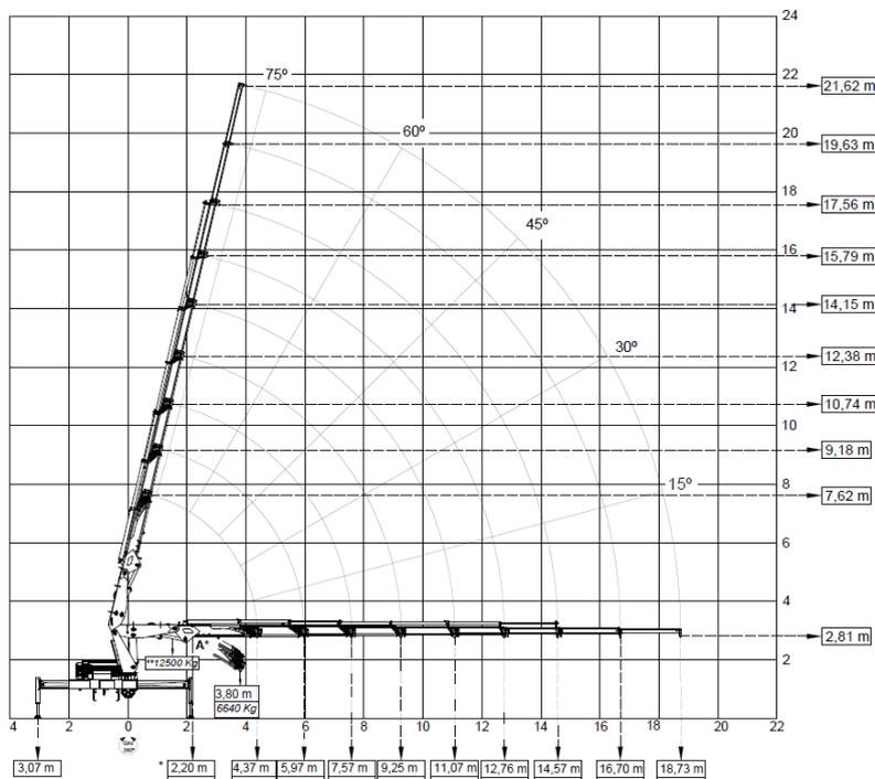
\*A El punto A es para izar cargas especiales, debiendo ser utilizada un grillete de unión Ø1" grado T.
