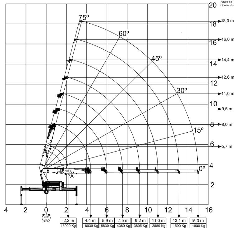
\* El punto A es para izar cargas especiales, debiendo ser utilizada un grillete de unión Ø1,3/4" grado T.
