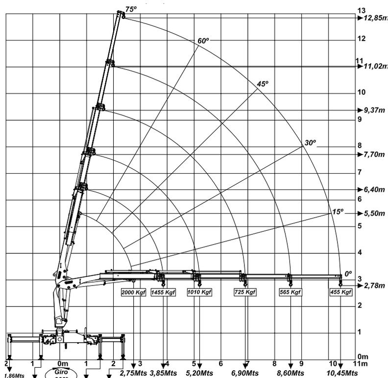
\* El punto A es para izar cargas especiales, debiendo ser utilizada un grillete de unión Ø3/4" grado T.
