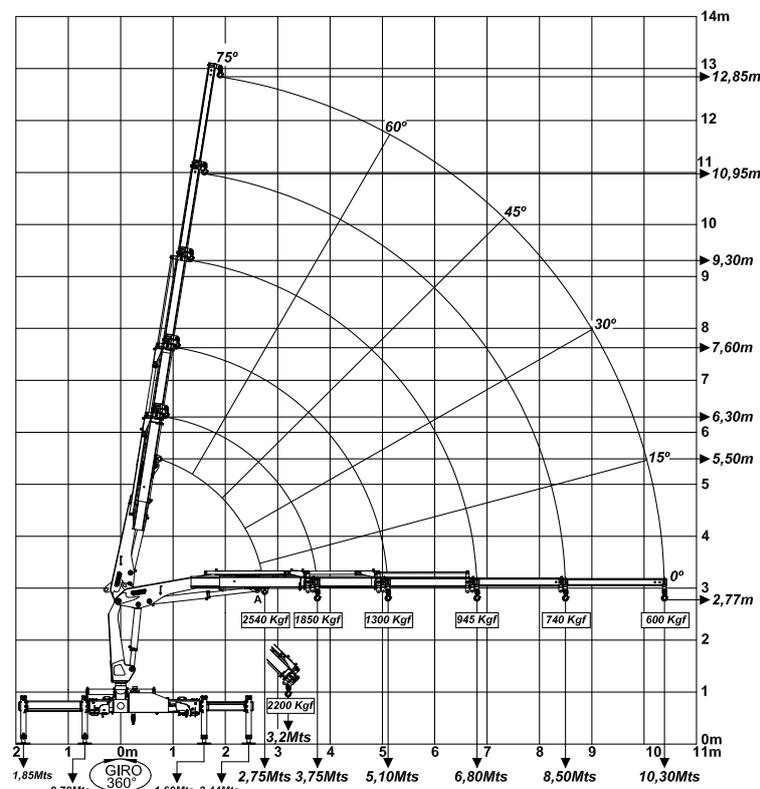
\* El punto A es para izar cargas especiales, debiendo ser utilizada un grillete de unión Ø3/4" grado T.
